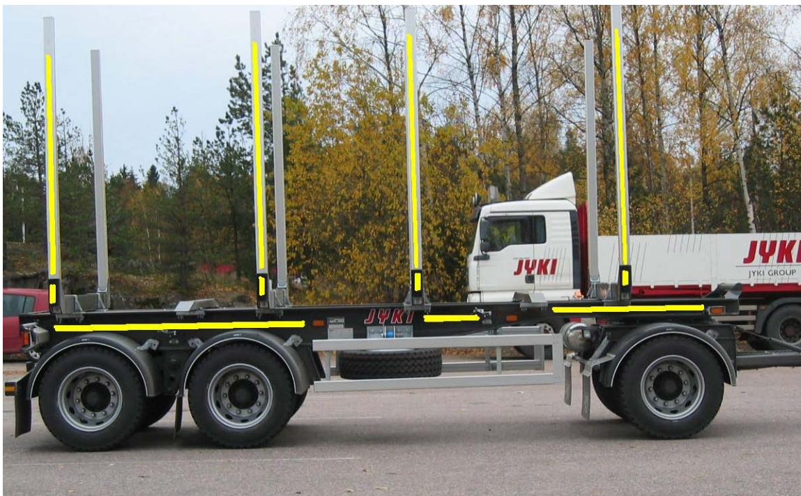
Kuva 3. Puutavaraperävaunu varustettuna keltaisilla heijastavilla merkinnöillä. Perävaunun rakenteen ja ominaisuuksien johdosta, riittävinä heijastavina merkintöinä voidaan pitää esimerkiksi pankojen alareunassa ja rungossa olevia nauhamaisia merkintöjä, jolloin pankoja siirrettäessä vaatimukset saadaan täyttymään riittäväällä tavalla. Oheisessa kuvassa myös pankojen yläosa on merkitty näkyvyyden parantamiseksi. Vetoaisaa ei tarvitse merkitä heijastavalla nauhalla.
