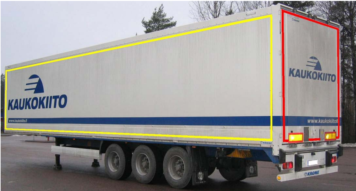
Kuva 2. Täydellinen ääriviivamerkintä ajoneuvon sivulla. Takana on käytettävä täydellistä ääriviivamerkintää. Väri saa olla sivuilla keltainen tai valkoinen ja takana punainen tai keltainen. Pitkän ajoneuvon kilpiä (ECE R70-01) voidaan hyödyntää takana merkinnän leveyden suhteen.
