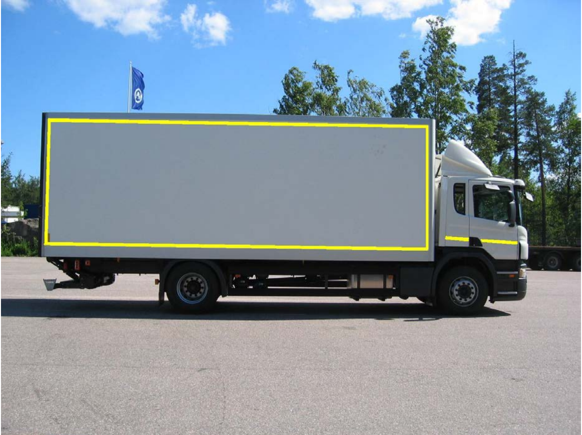
Kuva 7. Täydellinen ääriiviivamerkintä ajoneuvon sivulla. Väri saa olla keltainen tai valkoinen.
