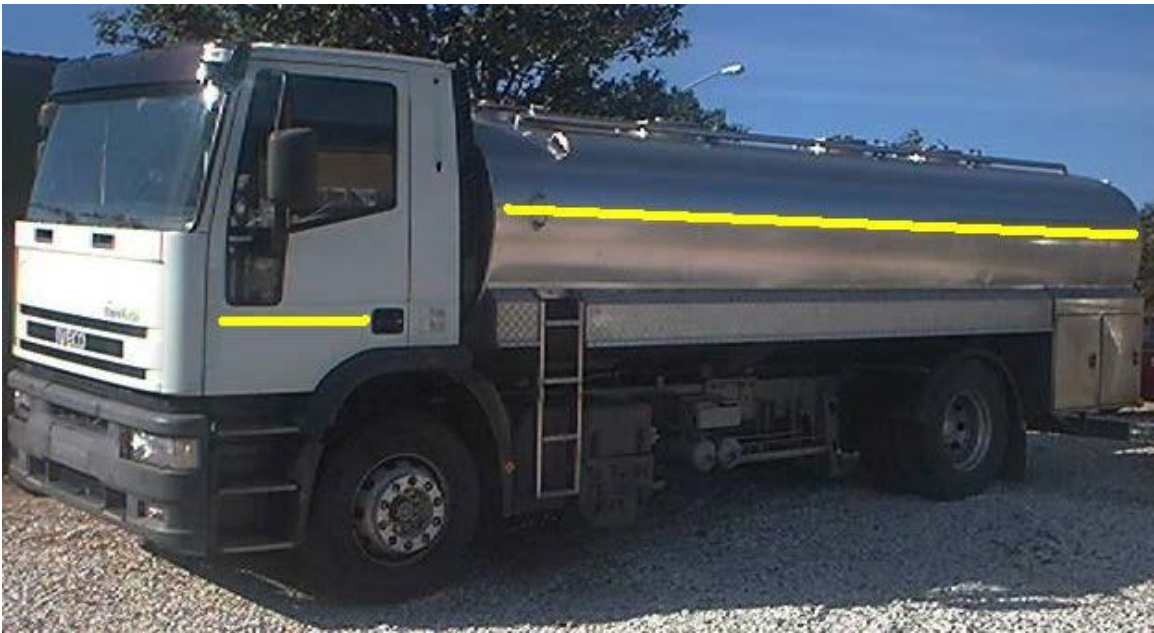
Kuva 10. Jos säiliö on lieriömäinen, voidaan osittainen- tai täydellinen ääriviivamerkintä korvata nauhamaisella merkinnällä. Merkintä tulee olla mahdollisimman kohtisuorassa tasossa. Merkinnän korkeus maasta voi olla yli 1500 mm (max. 2500 mm) jos sitä ei säiliön muodon johdosta voida asentaa enintään 1500 mm korkeuteen.
