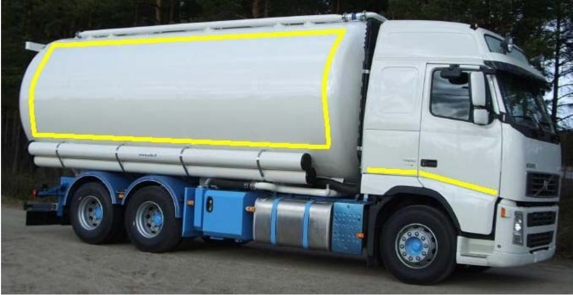
Kuva 9. Täydellinen ääriviivamerkintä. Merkinnän tulee seurata mahdollisimman tarkasti ajoneuvon muotoja jos ajoneuvon rakenne sen mahdollistaa.
