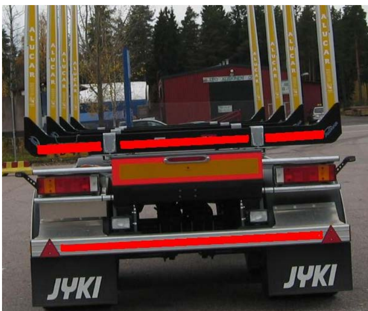
Kuva 4. Takaosa on merkitty kahdella punaisella heijastinnauhalla. Minimivaatimus on yksi heijastinnauha. Toinen puskuripalkissa ja toinen pankojen välisessä vaakapalkissa. Korkeusvaatimus maasta 250 – 1500 mm täyttyy kuvan mukaisessa rakenteessa molemmissa vaihtoehdoissa, myös merkinnän leveys 80% ajoneuvon leveydestä saadaan täyttymään.
